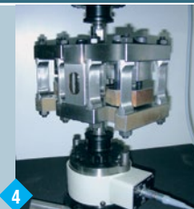
4 Устройство для испытаний на изгиб по 4 точкам
