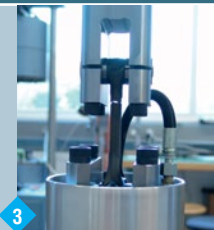
3 Усталостные испытания соединительной тяги
